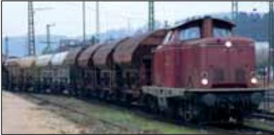
*Insgesamt ist geplant, pro Jahr rund 200.000 Tonnen Sand auf die Alb zu fahren. Dabei macht die Steigung auch der 212 zu schaffen und es werden bei trockenen Schienen maximal 400 Tonnen brutto pro Zustellung gefahren.*
